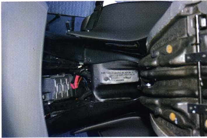
La sella è incernierata nella parte anteriore e si solleva con un movimento smorzato da un pistoncino idraulico.
