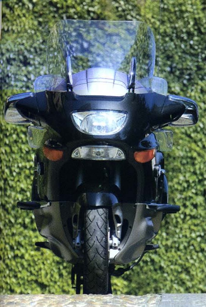
La vista frontale della LT con il parabrezza alto e poi abbassato. È facile in ogni caso apprezzare l'ampiezza della sezione frontale, che rende conto dell'ottima protezione aerodinamica.
