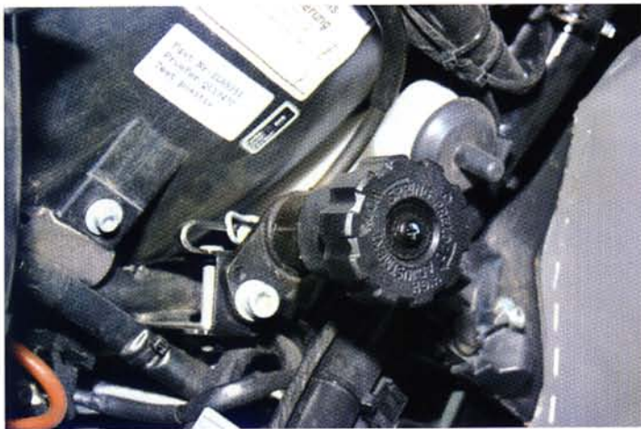
Sotto la sella è collocato il manettino tramite il quale è possibile regolare il precarico della molla dell'ammortizzatore posteriore. Può essere utilizzato in posizione verticale; una volta usato viene ripiegato su uno snodo e collocato in orizzontale per occupare meno posto.
