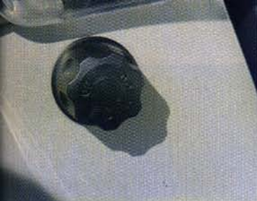
Questa manopola, posta sul lato destro della carenatura, regola l'altezza del fascio luminoso dell'anabbagliante.
