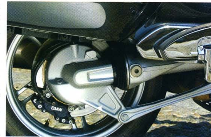
Il paralever che realizza la sospensione posteriore appartiene alla classica costruzione BMW ed ha subito un alleggerimento rispetto al tipo precedente.
