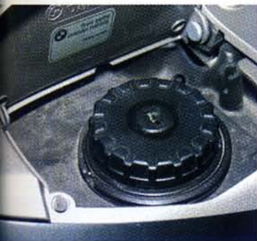
Sulla parte anteriore destra della carena, in posizione un po' sacrificata per l'interferenza del manubrio, uno sportellino nasconde il tappo del serbatoio del carburante.
