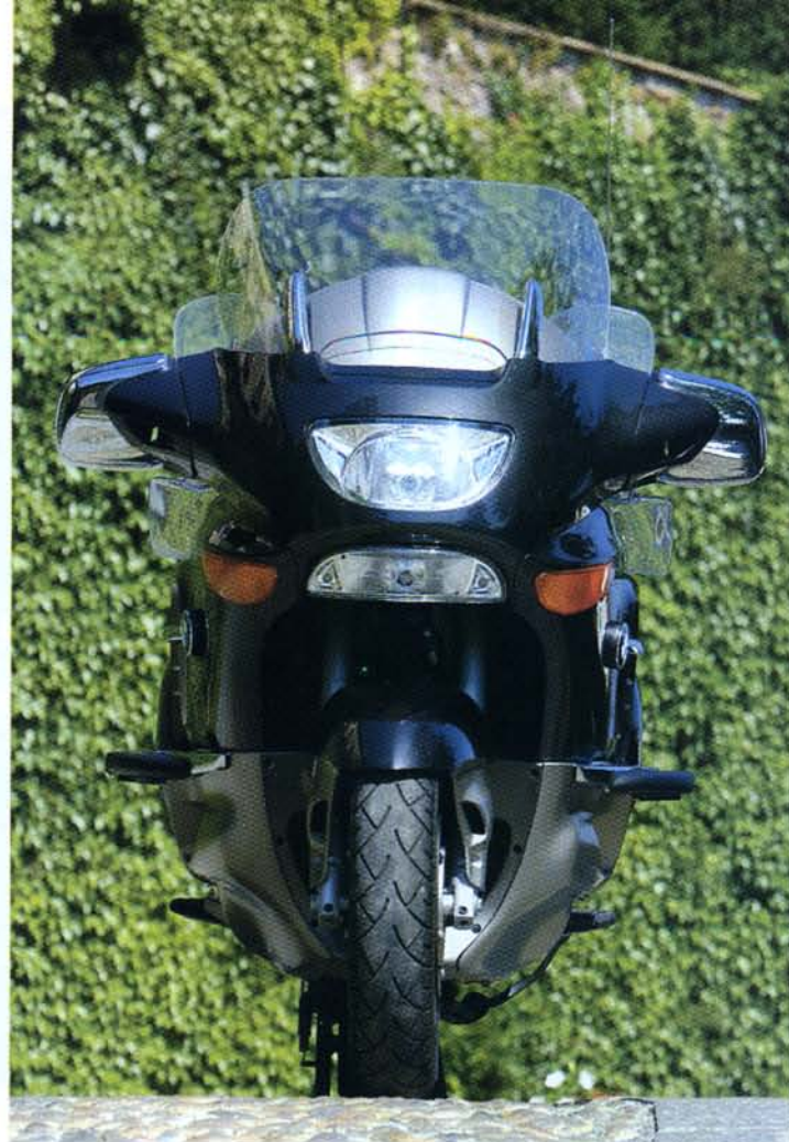
La vista frontale della LT con il parabrezza alto e poi abbassato. È facile in ogni caso apprezzare l'ampiezza della sezione frontale, che rende conto dell'ottima protezione aerodinamica.
