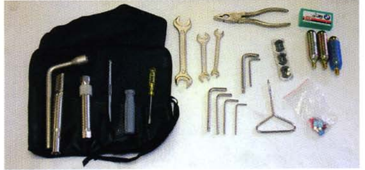
Per finire, la foto ci conferma la presenza anche sulla LT del classico kit di attrezzi BMW, comprendente un po' di tutto, incluso il classico kit per la riparazione del pneumatico.
