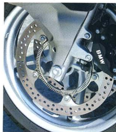
L'impianto frenante è degno di una sportiva, con pinze a 4 pistoni e dischi da 320 mm. Si osservi la ruota fonica dotata di 120 denti.
